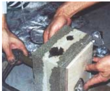
鑄造の前工程。鑄型を固定し鑄造に備える
