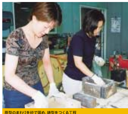
原型のまわりを砂で固め、鑄型をつくる工程
