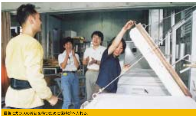
最後にガラスの冷却を待つために保持炉へ入れる。
