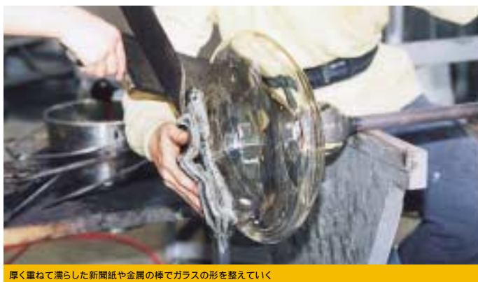
厚く重ねて濡らした新聞紙や金属の棒でガラスの形を整えていく
