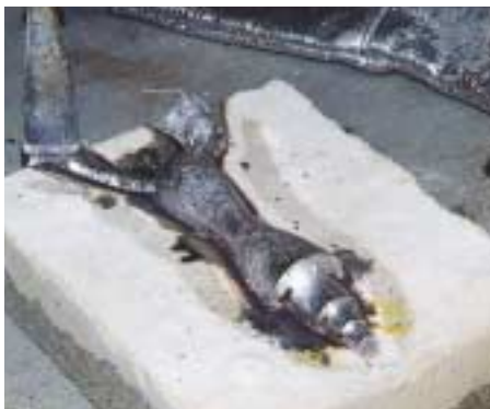
アルミの溶湯が固まり、砂型を分解した瞬間
