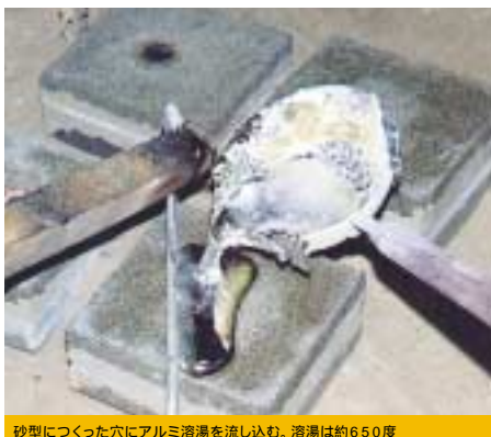
砂型につくった穴にアルミ溶湯を流し込む。溶湯は約650度
